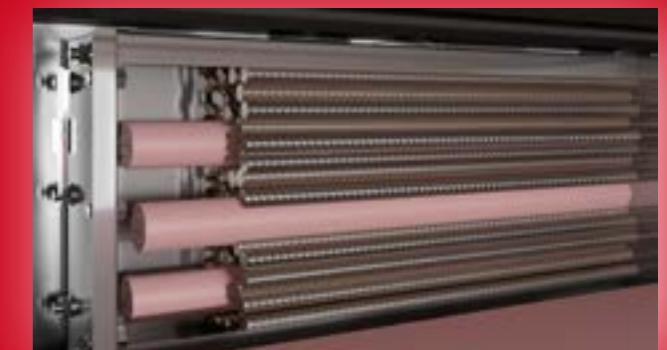
SALVA emplea un sistema de calentamiento del horno único en el mercado. Resistencias eléctricas de tungsteno insertadas en ladrillos cerámicos. Más del 90% del techo y del suelo es superficie radiante efectiva, controlándose de manera independiente el conjunto de resistencias en boca, suelo y techo.
